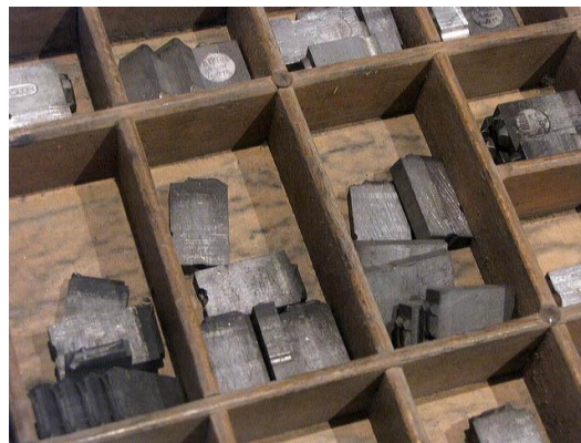
Scomparti della cassa tipografica coi singoli tipi divisi per ciascuna lettera o grafema
